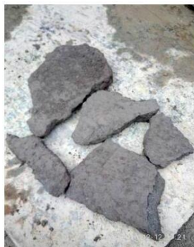
泥浆板框压滤后呈泥饼。
