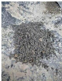
岩屑经振动、冲洗、晾干处理。
