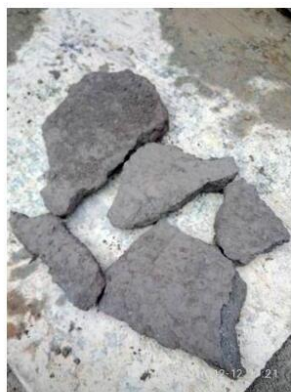
泥浆板框压滤后呈泥饼。
